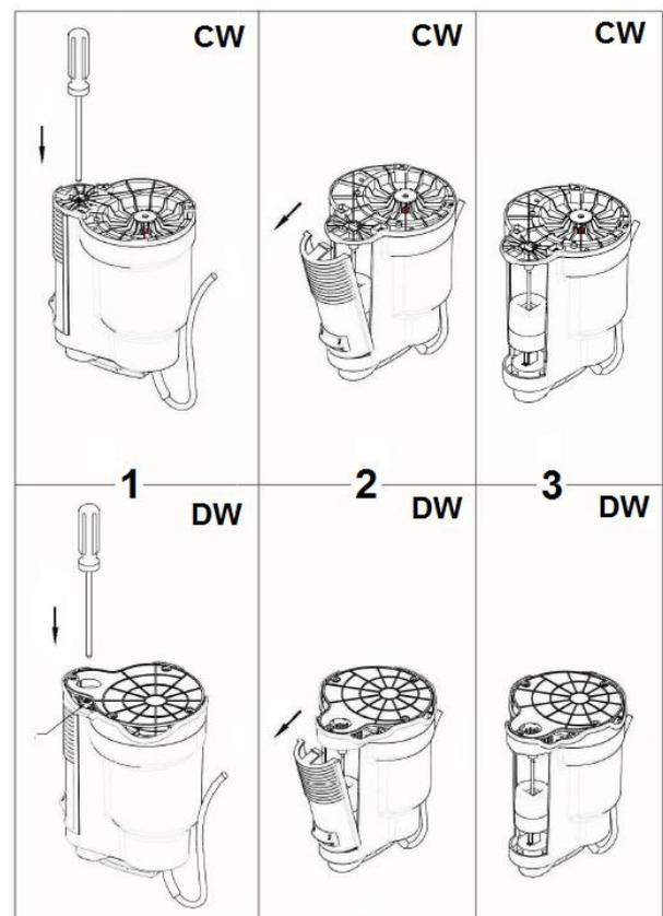
asennettu toimimaan automaattisesti. Poista uimuriin kertynyt lika säännöllisesti puhtaalla vedellä. Tee tämä kääntämällä pumppu ympäri ja avaamalla sivupaneeli tapilla tai vastaavalla (katso kuva). Poista uimuri akselinsa kanssa ja puhdista uimuri ja magneetti. Vältä vaurioita tai vääriä asennuksia, älä irrota uimuria akselista!
